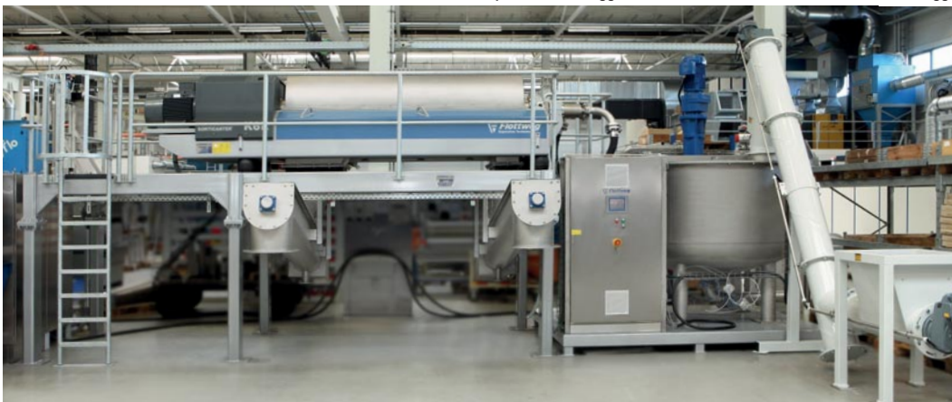
Da sinistra: Il SORTICANTER® con il scarico della fase solida, fase pesante, fase leggera, serbatoio di miscelazione e sistema di dosaggio
