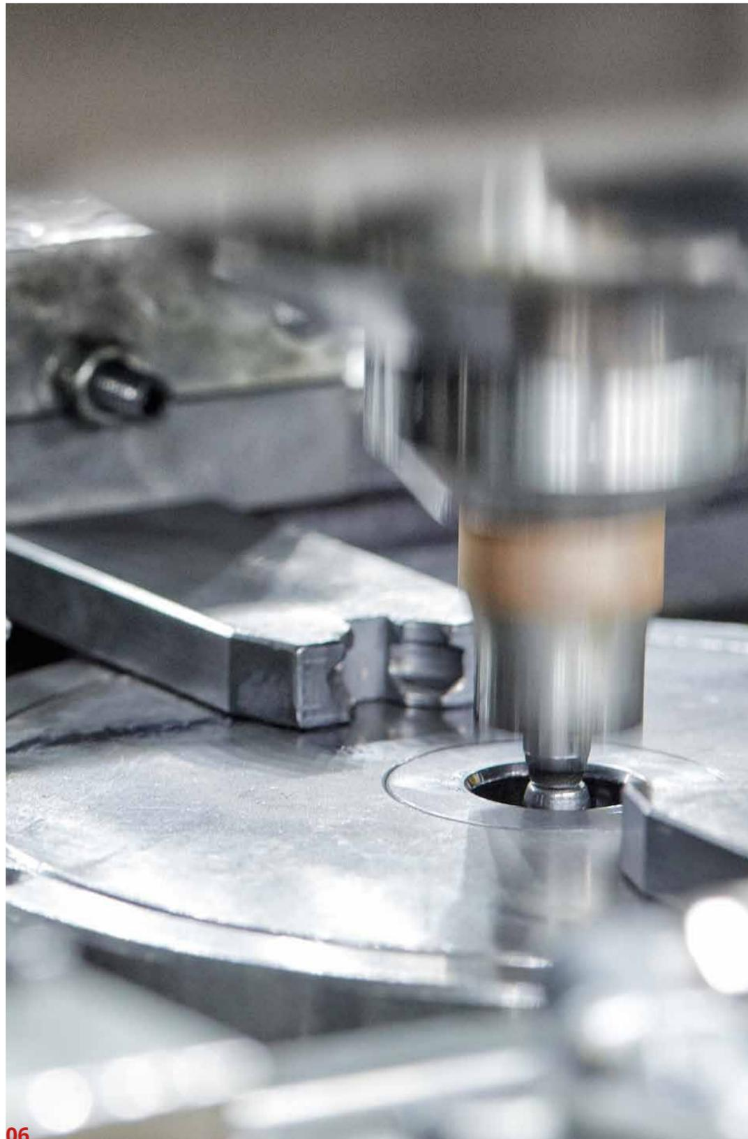
Bei der Kaltmassivumformung startet der Umformprozess bei Raumtemperatur. Das Werkzeug erfährt keine aktive Erwärmung und die Temperatur des Werkstoffs bleibt unterhalb der Rekristallisationstemperatur. Die massiven Rohlinge – in den meisten Fällen hergestellt durch Abscheren, Absägen oder Stanzen – werden unter so hohen Druck gesetzt, dass der Werkstoff zu fließen beginnt und die gewünschte Form annimmt.
