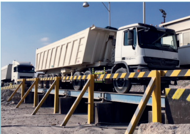
Le pesa a ponte per autocarri a resistenza elevata sono necessarie per le condizioni estreme dell'Emirato di Fujaira
