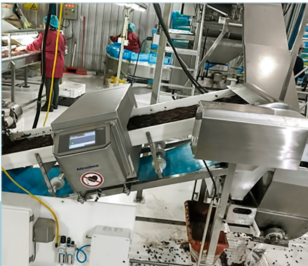
Montato sul sistema di motorizzazione inclinato, il rilevatore di metalli è poco ingombrante
