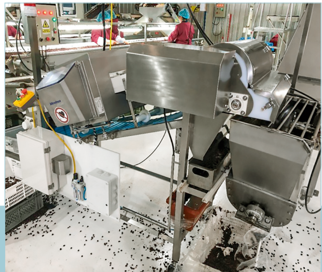
Tutti i prodotti espulsi vengono rimossi dal flusso del prodotto per mezzo di un deflettore a due vie
