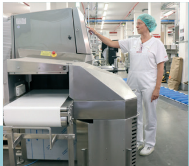
Il sistema di ispezione a raggi X Dymond sarà ora implementato permanentemente presso Anona nella parte finale della linea di produzione come punto di controllo critico
