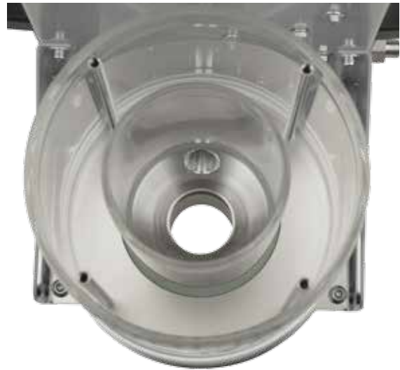
Particolare dell'entrata di aria secca e del distributore di aria
