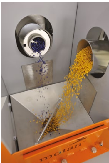
Principio di miscelazione a caduta
